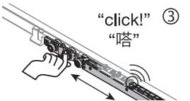
确认阻尼装置处于工作状态（复位弹簧已拉开）后，将门扇挂装至悬挂螺栓并紧固；
