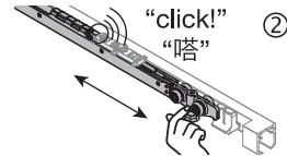
一体式双向阻尼需要将阻尼杆滑动至另外一侧，并通过相同动作将另外一侧的弹簧装置拉开；
